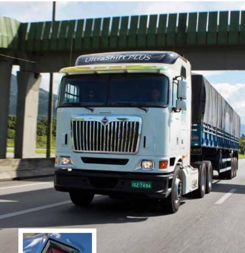
Outro detalhe que diferencia a cabine do International 9800i das demais de seu segmento é ser produzida em alumínio, o tornando-o um caminhão mais leve. Seu chassi é tratado termicamente, o que lhe garante a robustez e a resistência, por isso dispensa longarinas.
