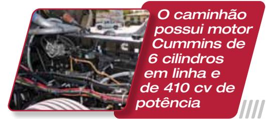
O caminhão possui motor Cummins de 6 cilindros em linha e de 410 cv de potência
